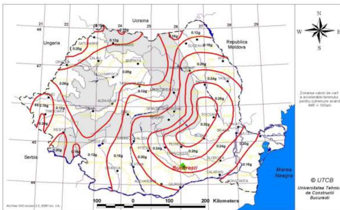
Figura 3 Zonarea teritoriului României în termeni de valori de vârf ale accelerației terenului pentru proiectare a_g pentru cutremure, având intervalul mediu de recurență IMR = 100 ani
